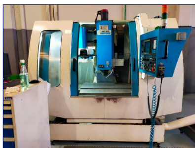
Centro mecanizado de mesa 1000x500.
