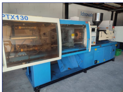
Inyectora 130 toneladas PROTECNOS PTX 130
